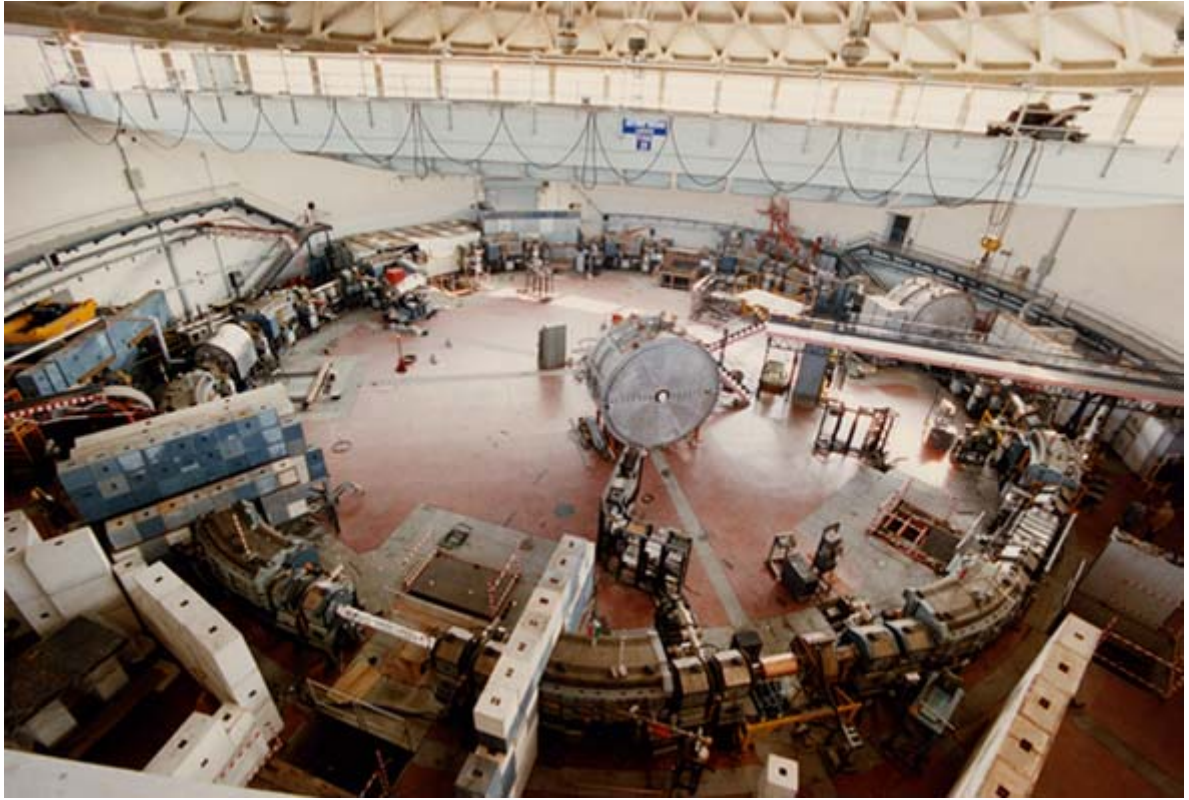
Fig. 4.6 - ADONE, anello di accumulazione e^+e^- , dei Laboratori Nazionali di Frascati dell'INFN
